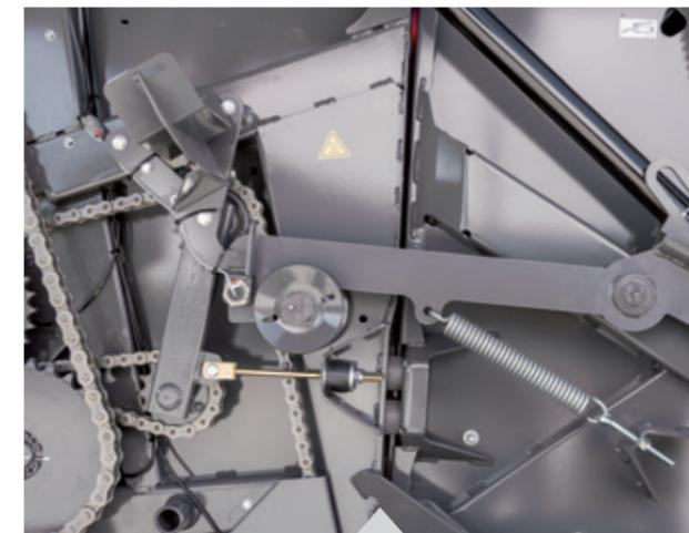
Die mechanische Heckklappenverriegelung arbeitet einfach, schnell und zuverlässig und sorgt so für einen einheitlichen Ballendurchmesser, eine höhere Ballendichte und einen geringeren Energieverbrauch.
