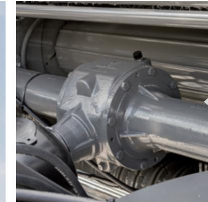
Das Powersplit-Getriebe teilt die Leistung gleichmäßig auf und überträgt sie entsprechend, um einerseits den Einzugsrotor und andererseits die Riemen und Walzen anzutreiben, wodurch der Kraftbedarf sehr gering ist. Die optionale Aufrüstung auf 1.000 U/min bietet folgende Vorteile:
