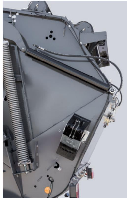
Das Volumen des Ballens nimmt beim Pressen exponentiell zu dessen Durchmesser zu. Parallel dazu wird kontinuierlich und automatisch die Riemenspannung erhöht, um für eine gleichmäßige Verdichtung zu sorgen.
