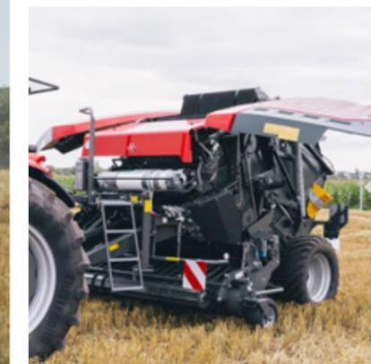
Die Seitenverkleidungen erstrecken sich über die gesamte Länge und bieten damit einen äußerst einfachen Zugang bei Wartungsarbeiten. Die glatte Oberfläche verhindert Staub- und Schmutzablagerungen unter den Verkleidungen, während die sichere Verriegelung ein unbeabsichtigtes Öffnen und somit eine Verletzung des Bedieners verhindert. Außerdem sind die Messer mit dem zusätzlichen Messerhalter jederzeit in Reichweite: je nach Schneidwerk 13, 17 oder 25 zusätzliche Messer.
