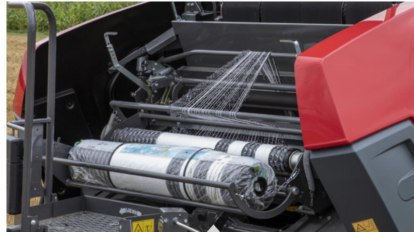
Dank des **Easy Loading System (ELS)** kann eine Ersatznetzrolle problemlos auf der Presse mitgeführt werden. So lassen sich die Rollen in wenigen Minuten wechseln. Zusätzlich zum ELS verfügen die meisten Modelle über ausreichend Platz zur Aufbewahrung einer zusätzlichen dritten Netzrolle an der linken Seite, wodurch die effektive Arbeitszeit auf dem Feld weiter erhöht wird.
