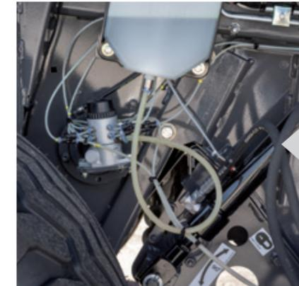
Die automatische Kettenschmierung ermöglicht eine individuelle Anpassung für jede Kette und gewährleistet stets eine optimale Ölzufuhr, wodurch die Wartungszeit verringert und die Lebensdauer der Ketten verlängert wird. Für maximale Langlebigkeit werden bei den Ballenpressen ausschließlich Ketten von höchster Qualität verwendet.
