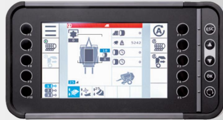
Die ISOBUS-Steuerung **E-Link Pro** verfügt über ein großes, helles Display, auf dem zahlreiche Parameter übersichtlich und gut lesbar angezeigt werden. So erhält der Fahrer mehr Informationen und eine noch bessere Kontrolle über die Ballenpresse.
