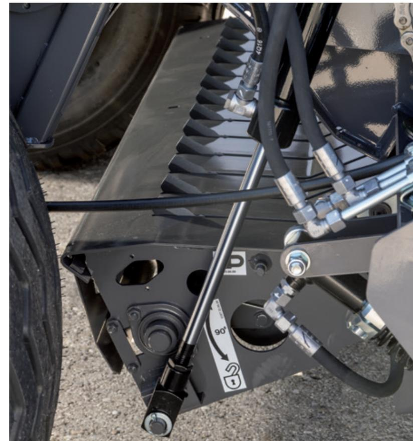
Die erste Stufe von Hydroflexcontrol sorgt dafür, dass sich der Vorderteil des Förderkanalbodens auf und ab bewegen kann, wodurch bis zu 80 % der potentiellen Verstopfungen verhindert und somit die Stillstandzeit gesenkt und die effektive Arbeitsleistung erhöht werden.
