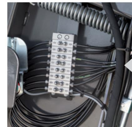
Eine regelmäßige und ausreichende Schmierung der Wellen- und Walzenlager ist überaus wichtig, insbesondere bei schwierigen Bedingungen, zum Beispiel beim Pressen von Silage. Zentrale Wartungspunkte zur Schmierung der Lager sind an gut zugänglichen Stellen positioniert und ermöglichen somit eine einfache und schnelle Wartung.
