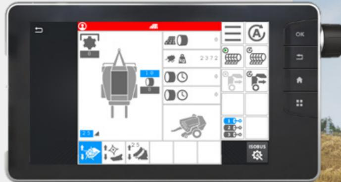
Wenn der Traktor ebenfalls mit ISOBUS ausgestattet ist, können die wichtigsten Informationen des Traktors und der Presse gleichzeitig über das Terminal des Traktors angezeigt werden.
