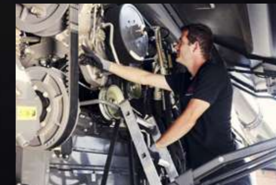
Vereinfachter Antriebsstrang, weniger Riemen und Ketten
