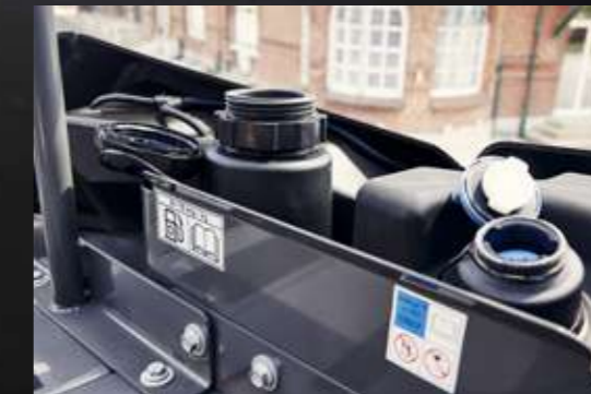
Tanken leicht gemacht - die Einfüllstutzen von Diesel- und AdBlue-Tank liegen nebeneinander
