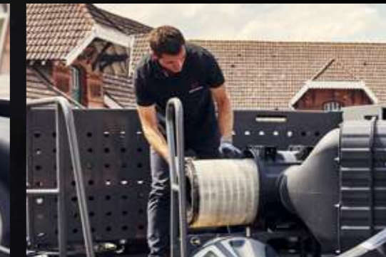
Gut zugänglicher Luftfilter erleichtert das Überprüfen und Reinigen
