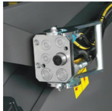
Der serienmäßige Schnellkuppler für Hydraulik und Elektrik sorgt für kürzeste Rüstzeiten.
