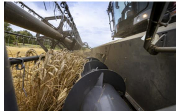
Beim FreeFlow-Schneidwerk sorgt die Einzugschnecke mit beweglichen Fingern auf voller Breite für einen kontinuierlichen Gutfluss.
