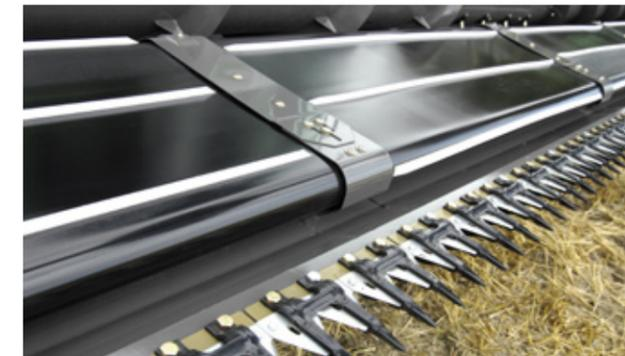
Für optimale Sicht und hohe Leistung beträgt der Abstand vom Messer zur Einzugschnecke ganze 1,14 m. Die PowerFlow-Bänder nehmen das Erntegut hinter dem Messer auf und führen es aktiv und gleichmäßig zur Einzugschnecke. Die Bänder werfen Steine zurück aufs Feld, bevor sie in die Maschine gelangen und dort Schaden anrichten könnten.
