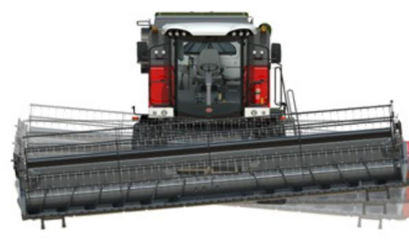
Der AutoLevel-Pendelausgleich ist zur Ergänzung der Schnitthöhenautomatik optional verfügbar. Das sanfte seitliche Pendeln gewährleistet eine gleichmäßige Schnitthöhe – dank dem perfekten Zusammenspiel von hochwertiger Hydraulik- und Elektronik.
