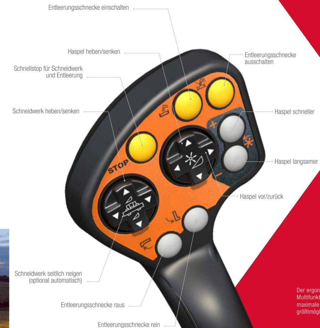
Der ergonomische Multifunktionshebel für maximale Kontrolle und größtmöglichen Komfort.
