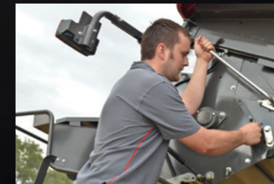
Einfaches Umstellen von Häckseln auf Schwadablage
