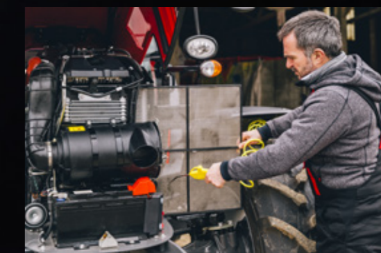
Die Kühleinheit ist leicht zu erreichen und lässt sich dadurch bequemer und schneller reinigen.
