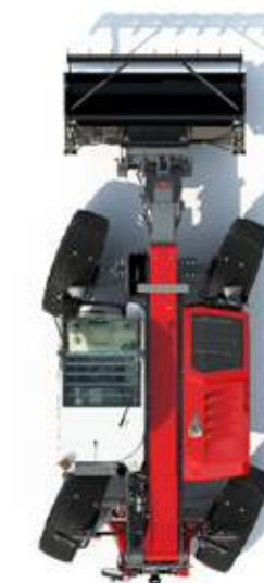
HUNDEGANG-LENKMODUS – für effizientes Befüllen und Planieren und für Arbeiten an Mauern und in engen Räumen.
