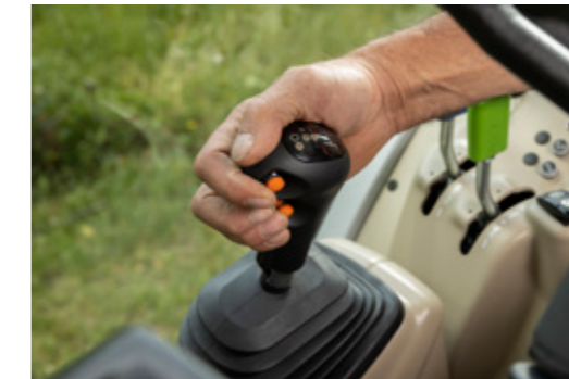
▲ Neuer Schalthebel mit Bowdenzug für einfache Bedienung.
