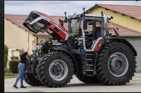
Das Design der Vorderachse und der schmalen Motorhaube erleichtert den Zugang zum Ölmesstab und zum Ölfilter.
