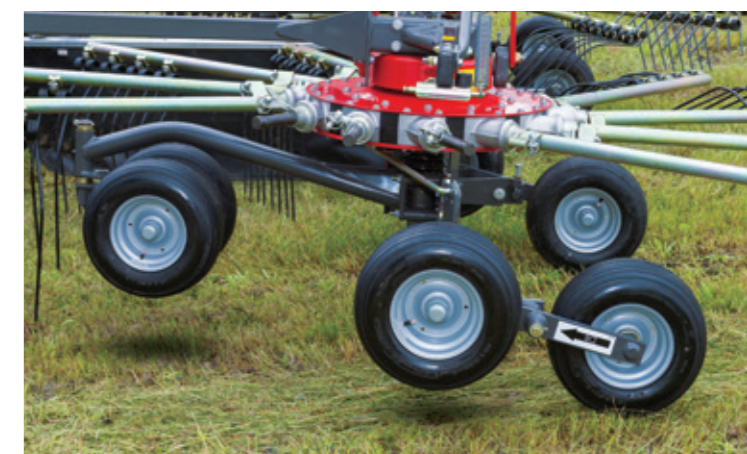
Patentované zavěšení rotoru pomocí kardanů.
