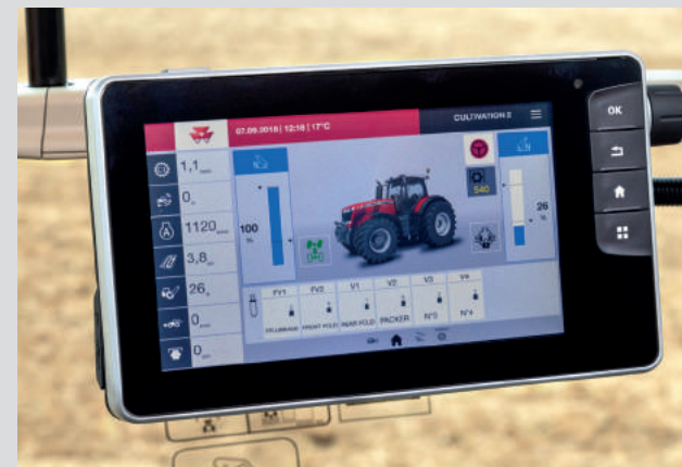
Řízení lisu pomocí terminálu ISOBUS traktoru
