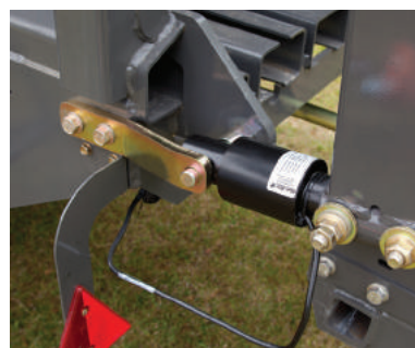
Snímače zatížení s vysokou přesností pro zabudovaný systém vážení balíků.
