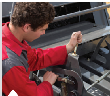
Jednoduché a spolehlivé nastavení délky balíku. Hvězdicové kolo pro délku balíku montované uprostřed lisovací komory se pohybuje s horními dvířky komory, což zaručuje pevnou trakci hvězdicového kola ve všech podmínkách sklizně a zlepšuje přesnost délky balíku.
