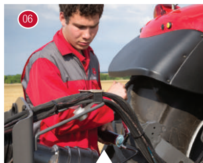
06 Promazávání vývodového hřídele.
