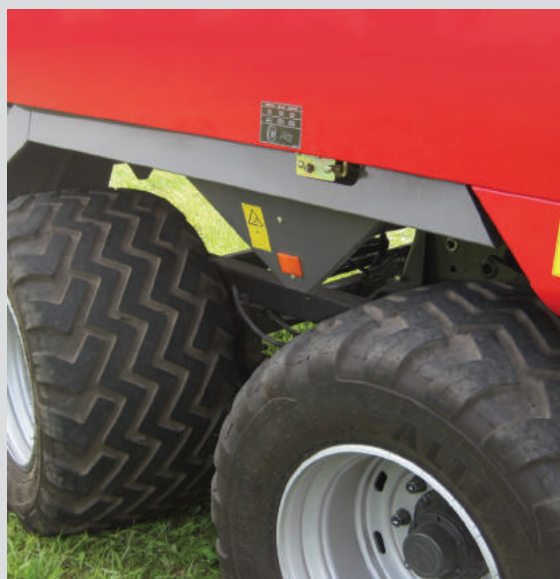
Volitelné radiální vysoko průchodné pneumatiky 620/40R22,5.*
