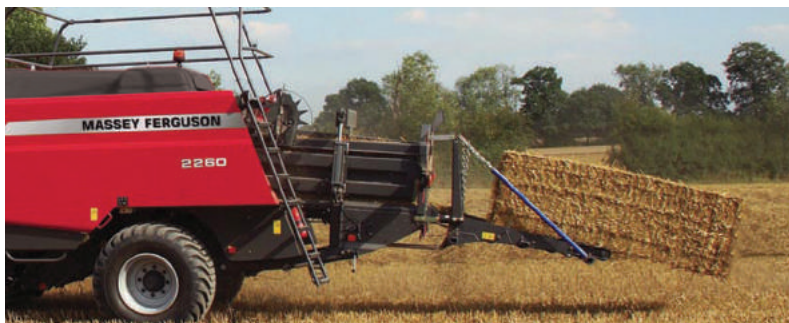
Zabudovaný systém vážení balíků zvaží balík při výstupu z komory na válečkový žlab.
