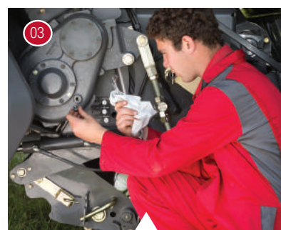
03 Kontrola hladiny oleje v převodovce řezačky.
