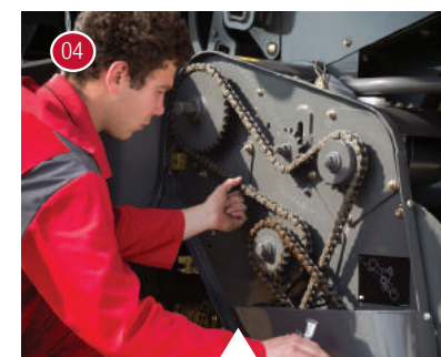
04 Kontrola napnutí řetězů pro sběrací ústrojí
