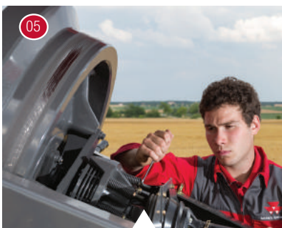
05 Seřízení spojky prokluzování setrvačnicku.
