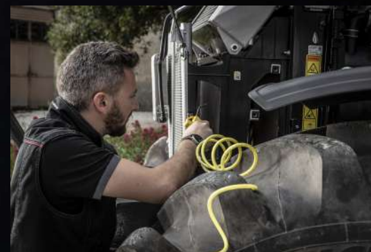
Chladič zařízení je snadno přístupný, takže jeho čištění je rychlejší a jednodušší.
