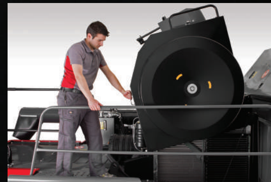
Bezpečný a snadný přístup pro čištění chladiče
