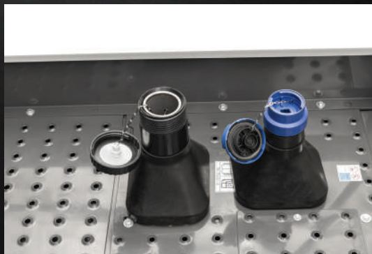
Snadné doplnění paliva - obě nádrže jsou umístěny vedle sebe pro snadný přístup
