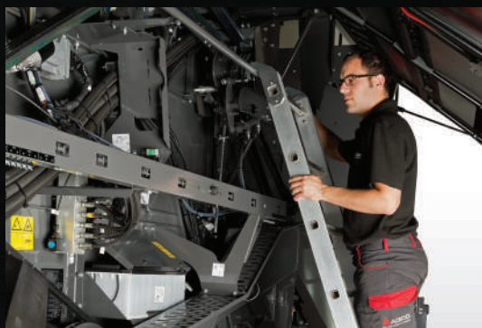
Schůdky se zábradlím zvyšují bezpečnost údržby a usnadňují ji
