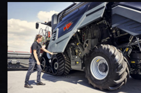
Jednodílné panely se světly umožňují rychlý a praktický přístup pro kontrolu
