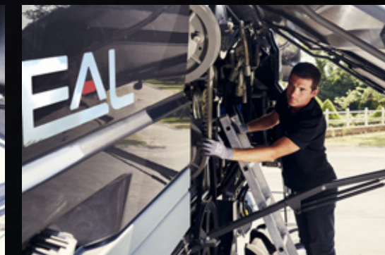
Přenosný zadní žebřík usnadňuje přístup po obvodu celého stroje
