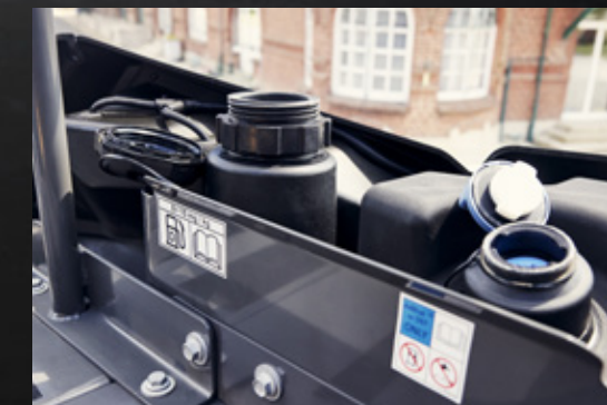
Snadné doplňování paliva - plnicí hrdla nádrže na naftu a AdBlue jsou vedle sebe pro praktický přístup
