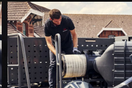
Snadná kontrola a čištění vzduchového filtru
