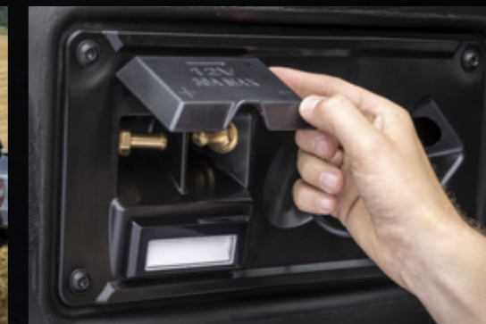
Díky volitelnému profesionálnímu balíčku získáte dvě elektrické zásuvky na 12 V v palivové nádrži, které napájejí externí palivové čerpadlo nebo čerpadlo na AdBlue®.
