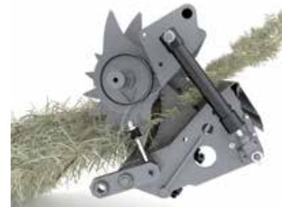
Patentirani sistem zaštite putem pažljivog spuštanja poda, koji je zavisno od modela na gumenim blokovima ili čeličnim oprugama, sprečava da maksimalna opterećenja dovedu do začepljenja.
