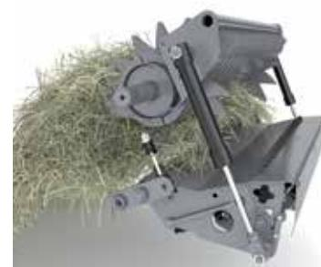
U slučaju začepljenja, vozač može lako da otvori pod dopremne komore i istovremeno spusti noževe kako bi osigurao dovoljno prostora za prolaz materijala.
