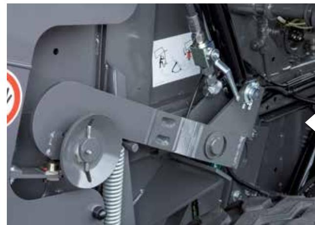
Potporni ležajevi valjaka u komori za bale poseduju samočisteće kućište koje omogućava da rastresiti materijal i vlagu izdu iz područja ležajeva i tako produžavaju vek trajanja.
