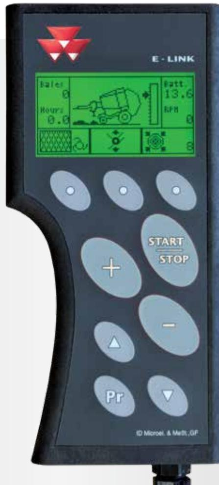
E-link upravljački uređaj kod MF RB 2125FPR balirke ima integrisane funkcije za praćenje i upravljanje svim ključnim funkcijama balirke. Ovaj ručni uređaj omogućava vozaču da unapred izabere hidraulične funkcije balirke kao i kontrolu nad gustom bala, dužinom mreže, izborom grupe noževa i pokazuje radno vreme i stanje različitih brojača bala.
