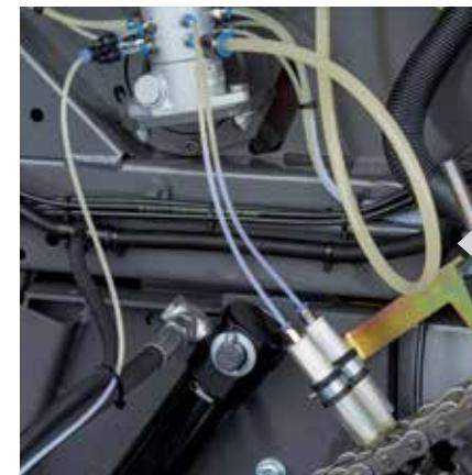
Automatsko podmazivanje lanca sa individualnim podešavanjem sa svaki lanac garantuje optimalan dovod ulja, čime se smanjuje vreme potrebno za održavanje i produžava vek trajanja lana. Za dodatnu optimizaciju veka trajanja u balirkama se uvek koriste lanci najvišeg kvaliteta.
