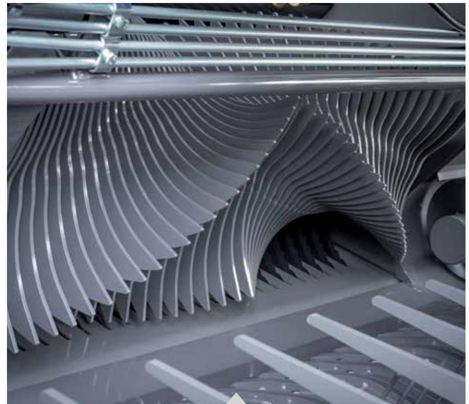
MF RB 2125FPR je serijski opremljen rezačem sa 25 noža
