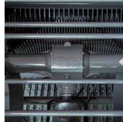
Powersplit prenosnik ravnomerno raspoređuje i prenosi snagu za pokretanje jedinice sa rotorom s jedne strane kao i za pogon valjka s druge strane, smanjujući ukupnu potrošnju energije pojednostavljenjem pogonskog sklopa. To kao rezultat ima efikasniju balirku koja troši manje goriva.
