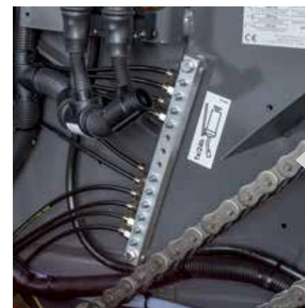
Redovno i dovoljno podmazivanje kotrljajnih ležaja je izuzetno važno, naročito u teškim uslovima, npr. kod baliranja silaže. Centralne tačke podmazivanja za kotrljajne ležaje su pozicionirane na pogodnim tačkama za lakši pristup i smanjeno vreme održavanja.
